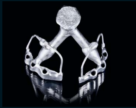
2 Der Steg wurde in einer NEM-Legierung gegossen, ausgebetet und gestrahlt. Anschließend wird der Steg mit Gramm-Fräsern ( \varnothing 1–3 mm) gefräst.
