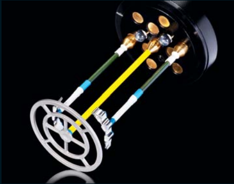
4 Der Steg wird mit einem Laboranalog verschraubt und im Galvanokopf kontaktiert.
