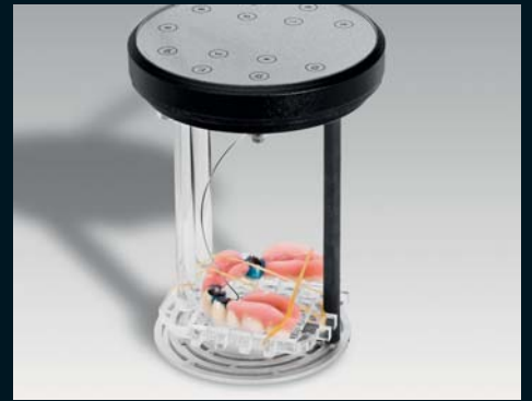
3 Die vorbereitete Arbeit wird mit einem Gummi an der Halteklammer befestigt und mit dem Galvanokopf kontaktiert.
